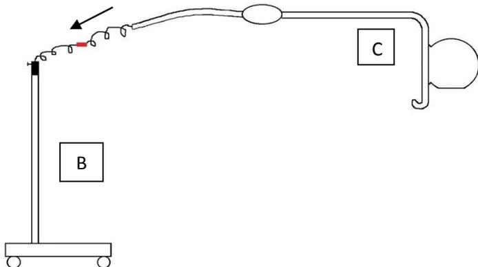
Introduire et pousser le câble et le connecteur à l'intérieur du tube B. Puis introduire le tube coulissant C dans B. La lampe est prête à fonctionner.
